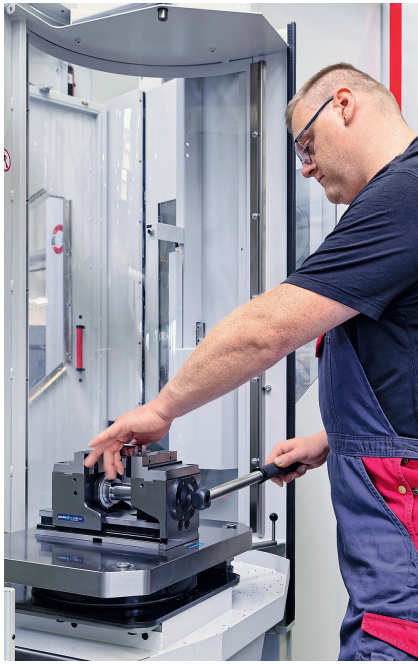
2 Mit dem Spannhebel und der 160°-Schnellspannung hat Stefan Giebel, Bediener des Hermle-Fräsdrehzentrums, das Werkstück innerhalb einer Sekunde im Kontec KSX gespannt © Schunk
